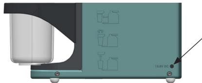
1. Schließen Sie das Netzteil an der Rückseite des Gerätes an.
